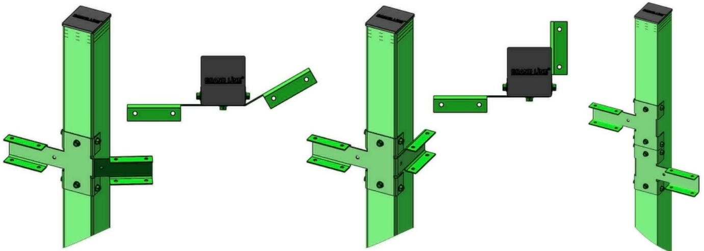
При необходимости панели можно закрепить ступенчато. Для этого на столб закрепляются дополнительные X-кронштейны. Таким образом, можно нивелировать неровности грунта. Неиспользуемое ухо X-кронштейна можно отпилить.
