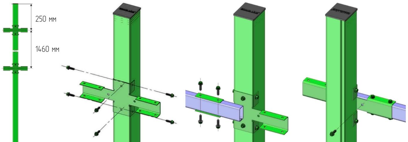
1. Установите трубы 40x20 длиной 2500 или 3000 мм в X-кронштейны и зафиксируйте их саморезами (5,5x19 мм). Торец трубы 40x20 должен совпадать с осью столба.
