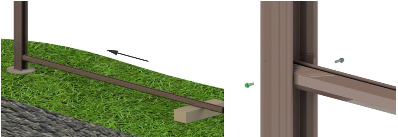
Установите второй столб. Расстояние между центрами столбов должно равняться 2504 мм. Произведите бетонирование столба. Закрепите в нем направляющую.
